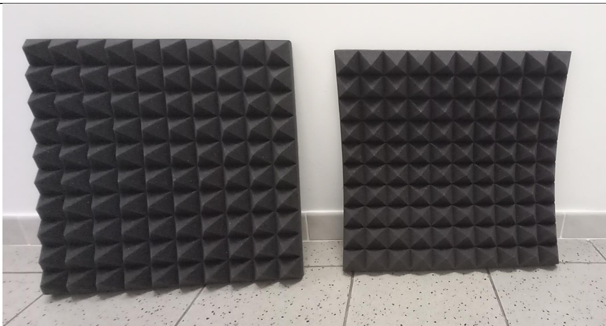
Figura 12 Pannelli fonoassorbenti dalla caratteristica forma piramidale
